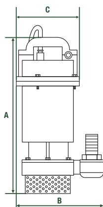
Las motobombas sumergibles de efluentes serie AQDX alojan un impulsor centrífugo tipo vórtex. Tienen aplicaciones en bombeo de cisternas, drenaje de granjas, riego de jardines, riegos agrícolas y suministros de aguas de uso doméstico e industrial. Son ideales para alta carga alcanzando hasta 98 ft (AQDX100).
