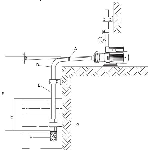
(\*) La altura de aspiración está determinada por la temperatura del líquido, altitud, resistencia al flujo y NPSH requerido por la bomba.
